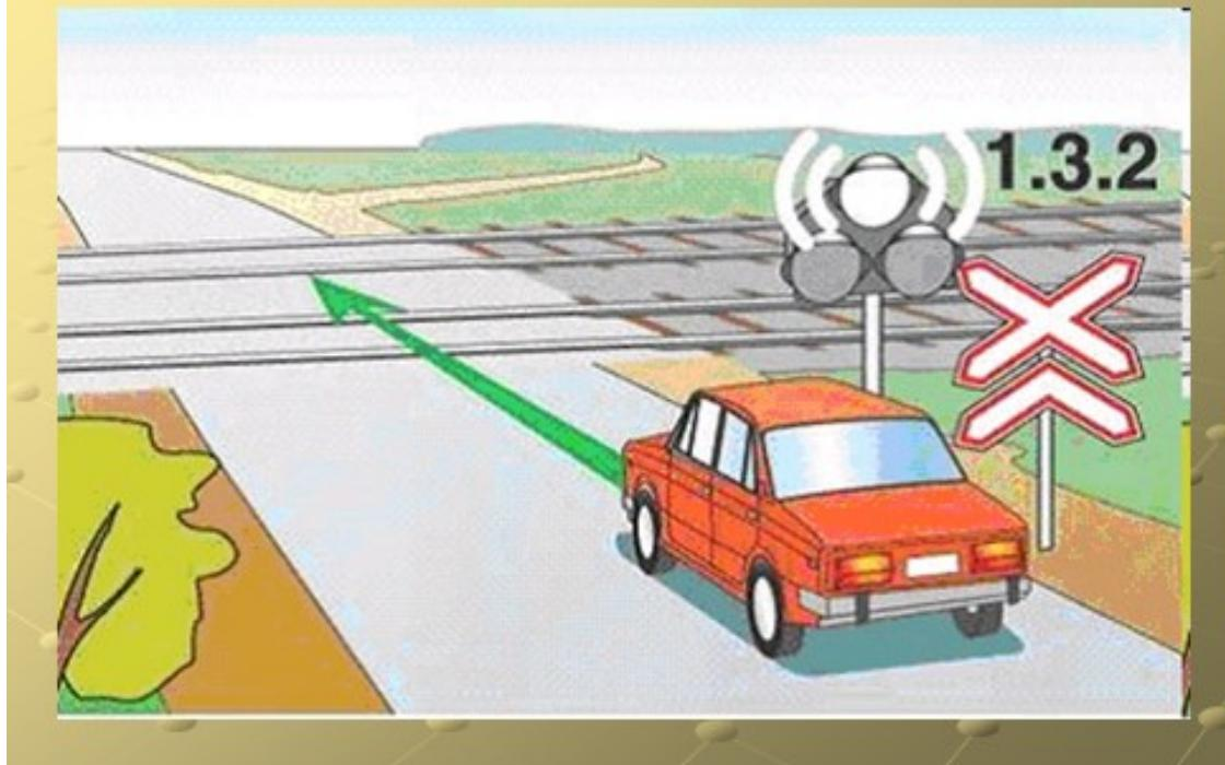
Два **попеременно мигающих красных фонаря** обозначают, что движение через переезд **запрещено**; данный сигнал обычно сопровождается **звуковой сигнализацией** (звонком).
